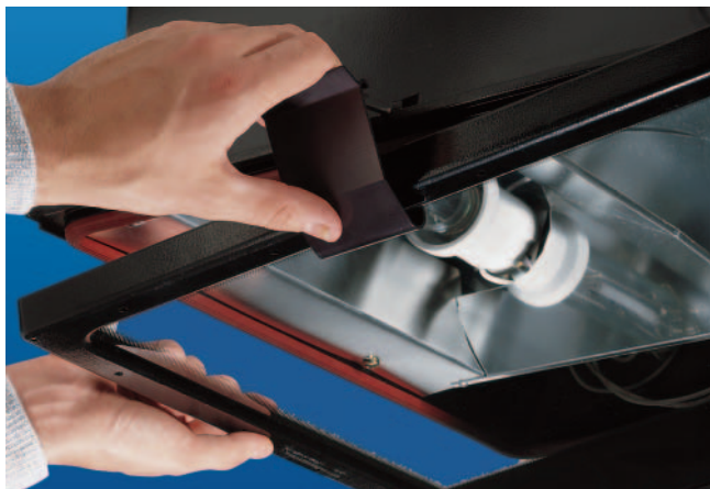
Después de aflojar los tres clips, se accede directamente a los auxiliares tras girar el vidrio protector alrededor de las charnelas.
